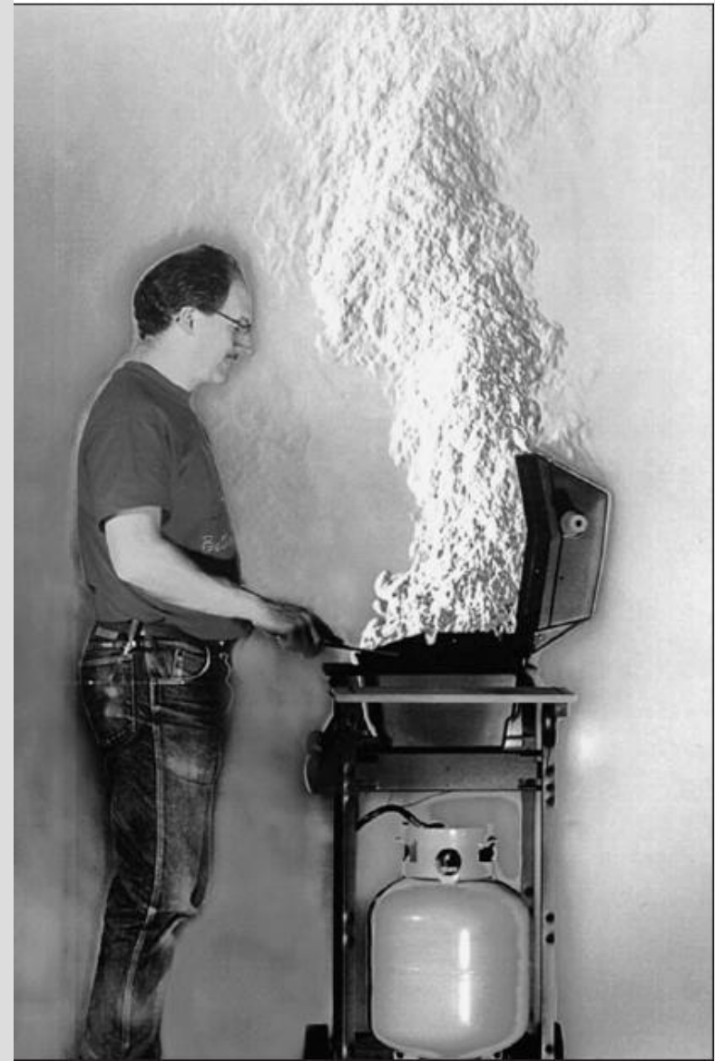
Barbekü ızgarasındaki doğal taşınımının şiliren görüntüsü.
