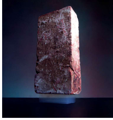
◉ 2.5 kilogramlık bir kaya parçasını taşıyan 2 gram ağırlığındaki aerogel parçası
