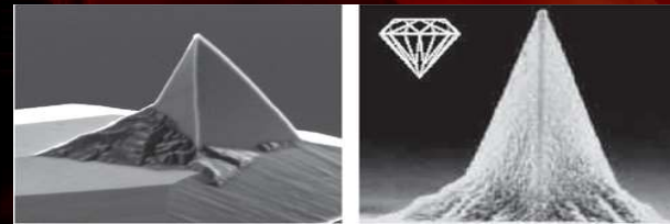
Şekil 6.3. Solda standart AFM tarama ucunun SEM görüntüsü, sağda ise iletken elmas film ile kaplı AFM tarama ucunun SEM görüntüsü görülüyor.
