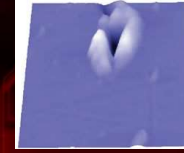
Şekil 6.12. PMMA yüzeyi içindeki AFM tarama ucu ile yapılan bir çentik.
