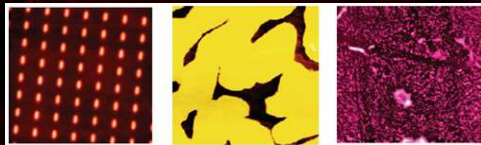
Şekil 6.6. Kontak mod görüntüleri. Solda küçük bir kompakt disk üzerindeki parçalar, ortada metal yüzey görüntüsü, sağda ise yüzey üzerinde nanopartiküller görülmektedir.
