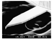
AFM uç, atomik boyutta düzenleme, görüntüleme ve ölçüm yapma amacıyla kullanılır.
