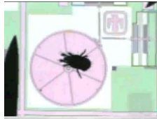
Mikro bir motor üzerinde bir mite (Sandia National Lab)
