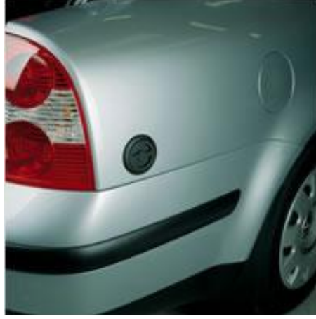
Resim 1.4: LPG/doğal gaz için araç üzerinde dolun kapağı
