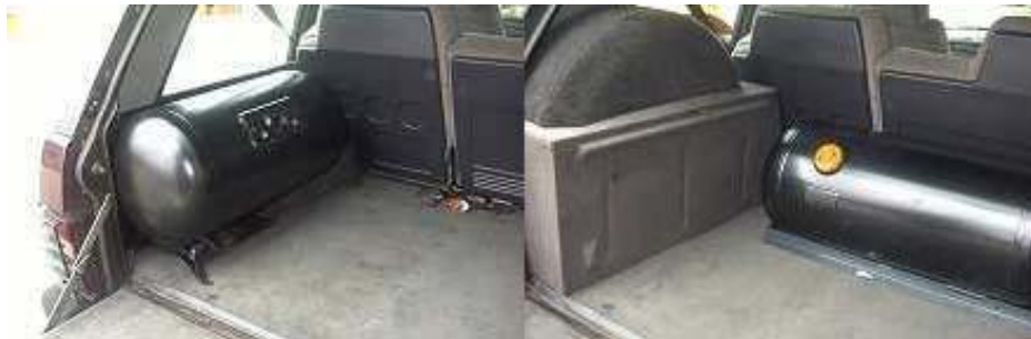
Resim 1.8: Silindirik LPG deposu
