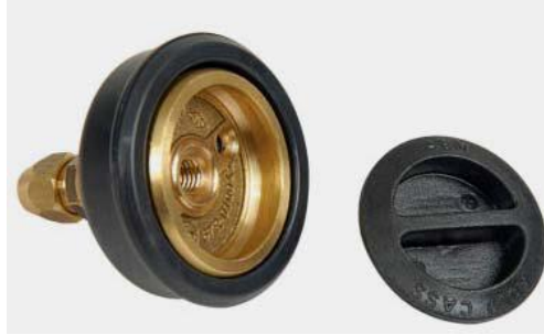
Resim 1.5: LPG/doğal gaz dolun ağızı ve kapağı
