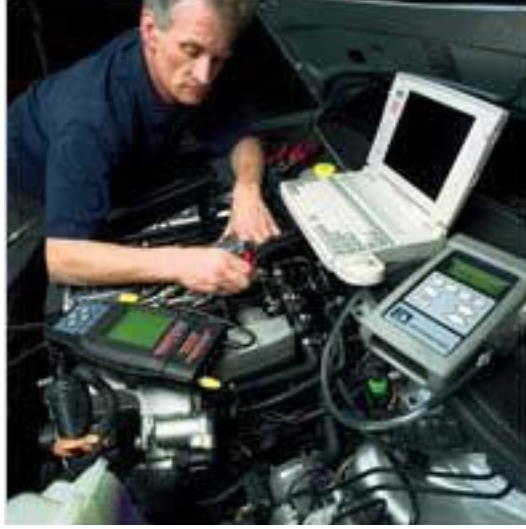
Resim 2.11: LPG/Doğal enjeksiyon sisteminin test cihazı ile kontrol edilmesi
