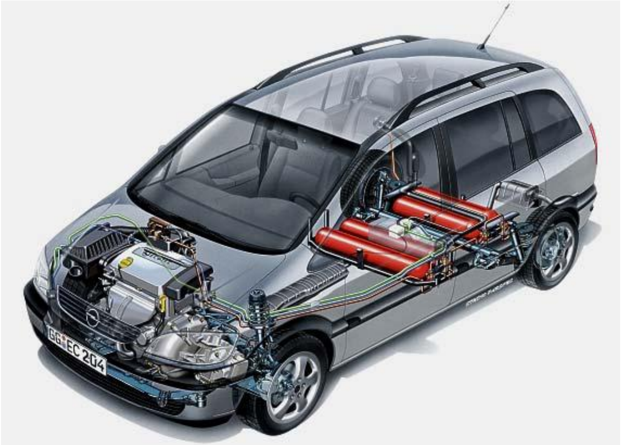
Resim 1.10: Silindirik LNG doğal gaz deposu
