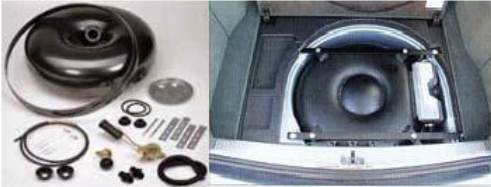
Resim 1.7: Simit şeklinde LPG deposu
