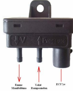
Resim 2.4: LPG/doğal gaz basınç ayar regülatörü ve basınç sensörü
