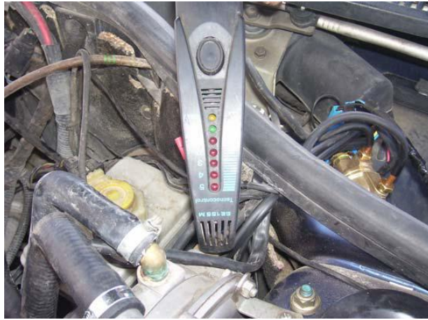
Resim 1.29: Regülatör gaz kaçaklık kontrolü
