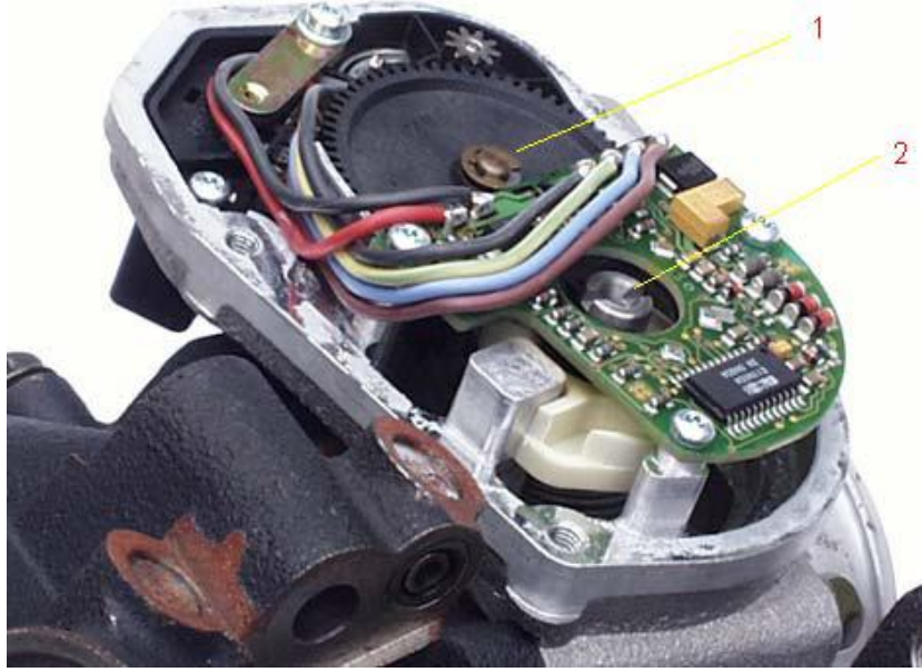
Şekil 2.8: EGR sisteminin iç yapısı (1. kelebek mili kontrol motoru 2. kelebek mili)
