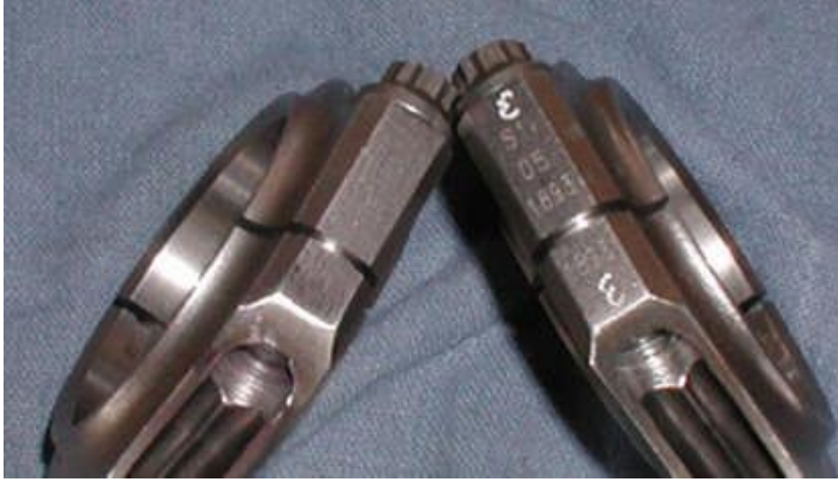
Şekil 1.26.A: Biyel kepi üzerindeki işaretler
