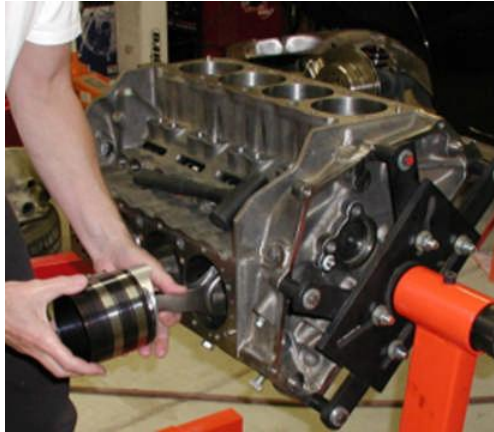
Şekil 1.24.A: Pistonun silindir içerisine takılması
