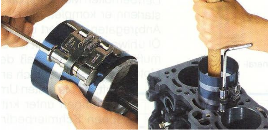
Şekil 1.24: Segman bandı ile segmanın sıkılışı ve silindirlere takılması
