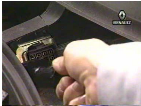
Şekil 2.2: Arıza tespit cihazının bağlantı soketi
