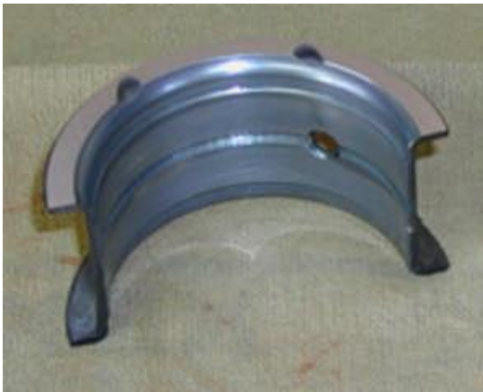
Şekil 1-46.A: Kusinetli yatak yağ kanalları Şekil 1.46.B: Muylu üzerinde yağ kanalları
