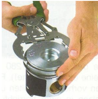
Şekil 1.23: Segman pensesi ile segmanın pistondan çıkarılışı
