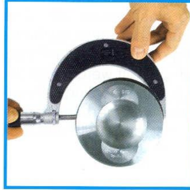
Şekil 1.10: Pistonun mikrometre ile ölçülmesi
