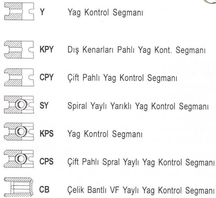
Şekil 1.19: Çeşitli yağ segmanı kesit görüntüleri
