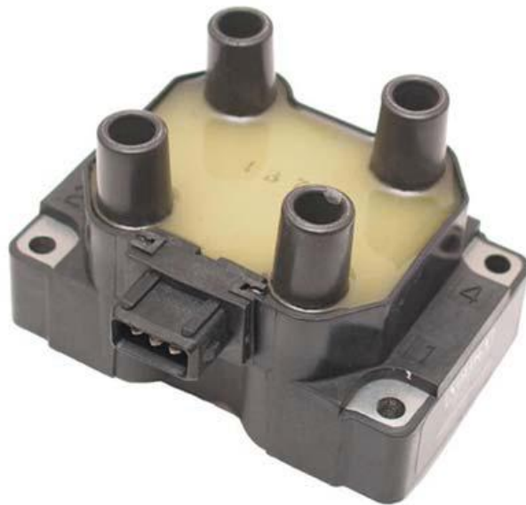
Resim 2.25: Distribütörsüz ateşleme sisteminde kullanılan ateşleme bobini
