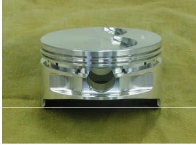
Şekil 1.5: Piston yağ akıtma delikleri
