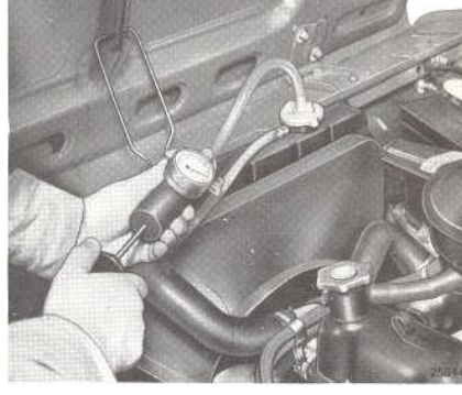
Şekil 1.24: Radyatör kapak testi
