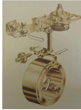
Şekil 3. 3: Yakıt ayar halkaları
