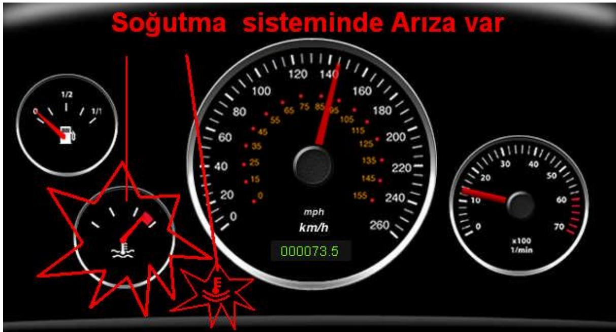
Resim 1.25: Soğutma sistemi ikaz göstergesi arıza bildirimi
