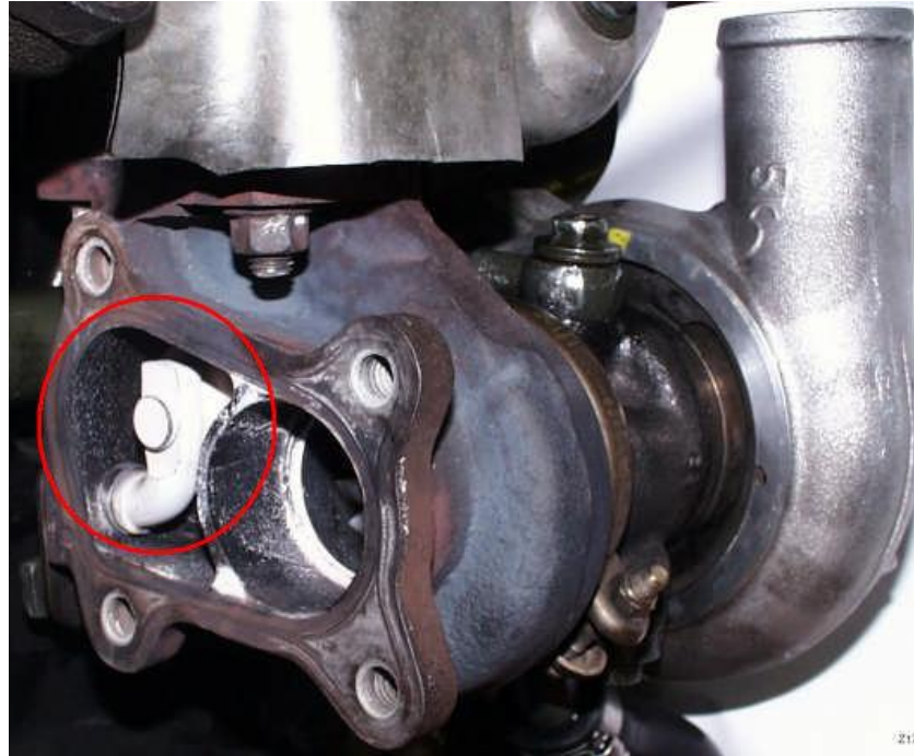
Resim 2.38: Türbin üzerindeki eksoz valfi
