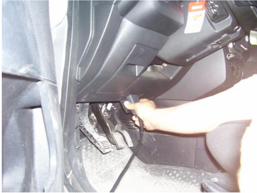
Resim 1.17: Diyagnostik cihazı data ucunun araca bağlanması
