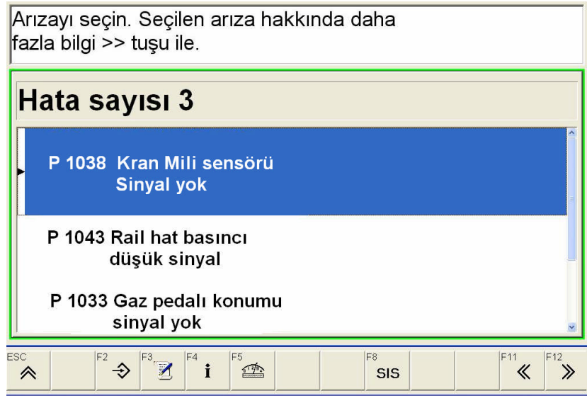
Resim 2.20: Diyagnostik cihazı arıza hafızası ekranı
