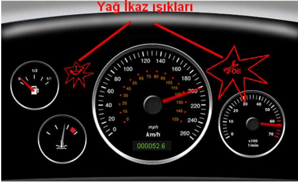
Resim 1.15: Yağ ikaz göstergesi arıza bildirimi
