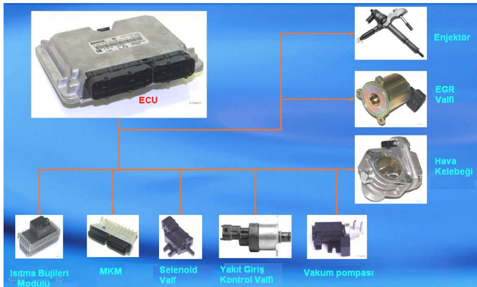
Resim 2.14: Common rail yakıt sisteminde ECU'nun kontrol ettiği aktörler
