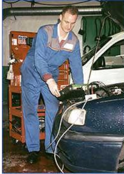
Resim 2.1: Enjektör temizleme işlemi
