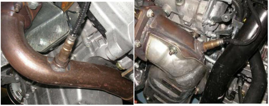
Şekil 6.4: Oksijen (lamda) sensörünün motor üzerindeki yeri
