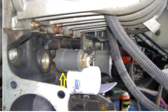
Şekil 14.3: Motor yağ basınç sensörünün motor üzerindeki yeri
