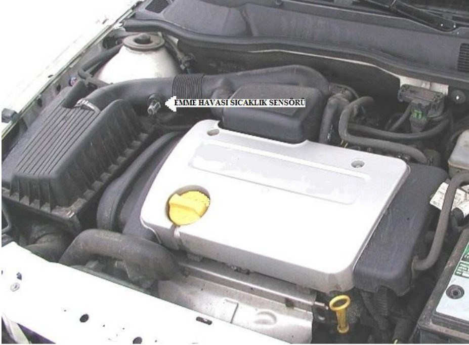
Şekil 2.4: Emme havası sıcaklık sensörünün motor üzerindeki yeri
