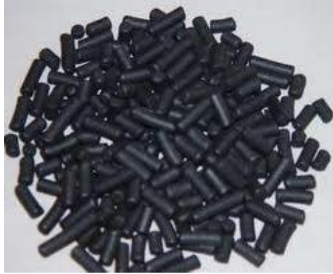
Şekil 5.6: Aktif karbon filtresinin içerisindeki karbon maddesi
