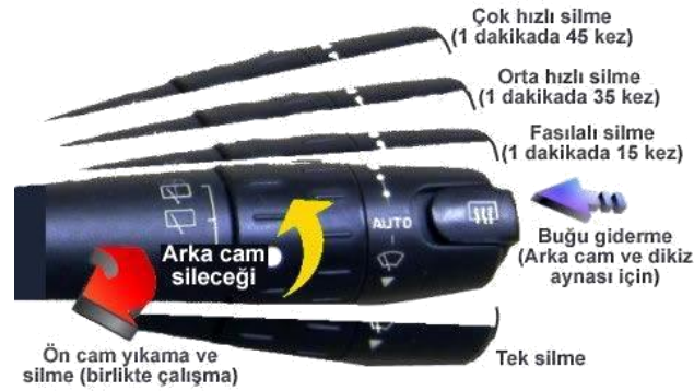
Resim 2.5: Cam silecek kumanda kolunun çalışması
