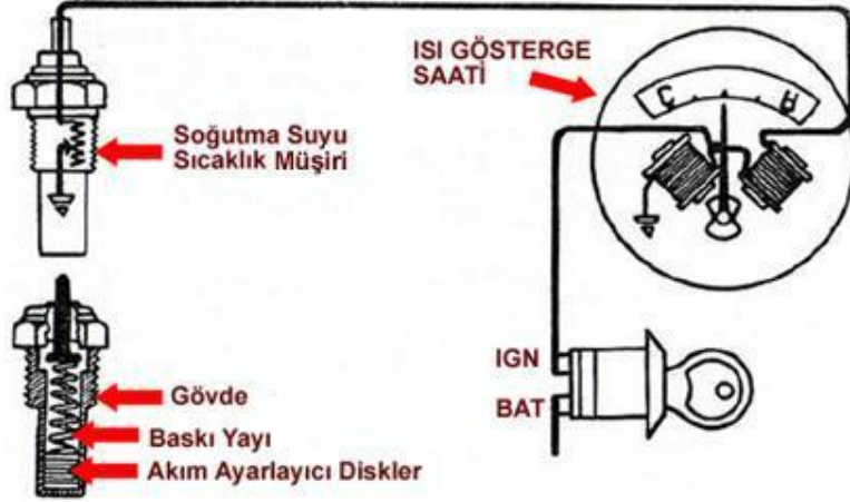
şekil 1.15: Manyetik sıcaklık göstergesi devresi
