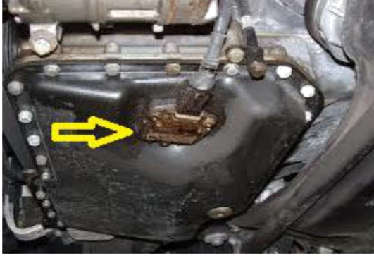
Şekil 14.3: Motor yağ seviye sensörünün motor üzerindeki yeri
